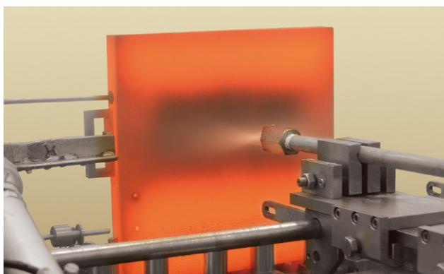
熱センサーを埋め込んだ鋼板を加熱し、そこへスプレーすることにより、熱伝達係数 (HTC) 分布や、平均熱伝達係数を求めることができます。データは冷却性能の評価に用います。
