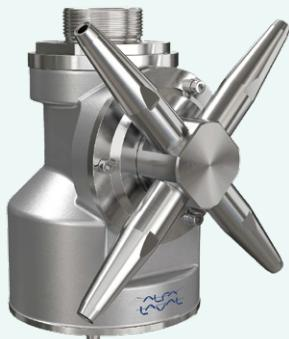
マルチジェット 45 は産業用途で使用するロータリージェットヘッドのタンク洗浄機です。最大容量 500m<sup>3</sup>n のタンクの洗浄に対応し、圧力と流量を組み合わせることで、再現性と信頼性の高い 360 度の洗浄パターンで回転する高インパクトの洗浄ジェットを生成します。
