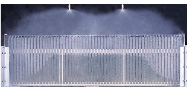
ノズルから噴射及び噴霧された流体は、いろいろな密度分布を持っています。通常の設計においては、圧力、流量、噴射範囲等から行いますが、ノズルによっては、幅方向の水量密度の均一性が得られない場合があります。また、高度な均一性が必要な場合は、水量分布の検証が不可欠となります。
