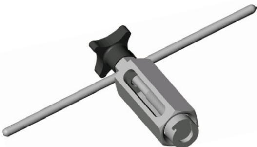
キャップを取り外した後、ノズルチップの溝部に装着し、ハンドルを回すことによりノズルチップが取り出せます。
