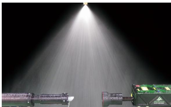
ストロボと CCD カメラをベースの画像解析により、粒子の形状（球形・非球形）や種類（透明・不透明）に限定されることなく、粒子径を測定できます。比較的大きい粒子の測定に適しています。
